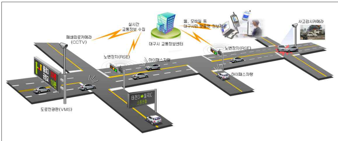
<그림 4-4> 첨단교통관리시스템(ATMS) 개념도
